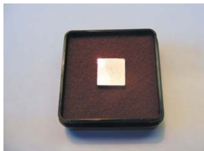
Рис.1. Образец ВОПГ 10x10 мм 2 , толщина 2 мм, мозаичность 1,7±0,5°
