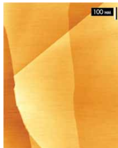
Рис.1. Изображение четырех атомно-гладких террас на поверхности графита (АСМ ФемтоСкан)
