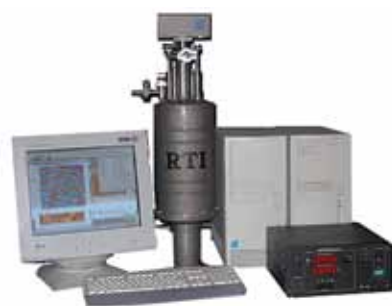
Рис. 8. СЗМ КριοСкан –2200 для исследования образцов при низких температурах
