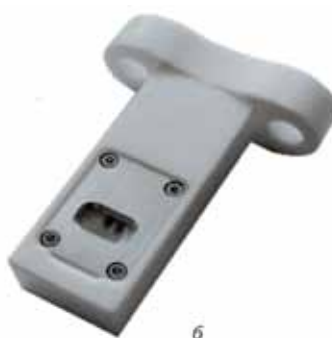
Рис.7. Атомные весы "БиоСкан" – микрокантилеверный анализатор химических и биологических веществ в жидких средах (разработаны совместно с ООО "Академия биосенсоров") (а); проточная жидкостная ячейка и держатель кантилевера атомных весов (б)
