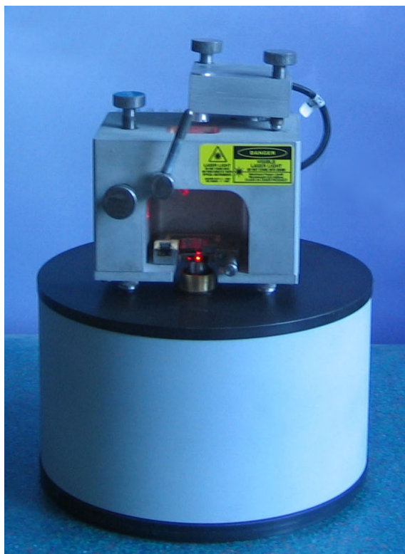
Рис. 1.2. Механическая система микроскопа ФемтоСкан.
