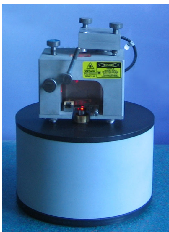
Рис. 1.3. Механическая система микроскопа ФемтоСкан.
